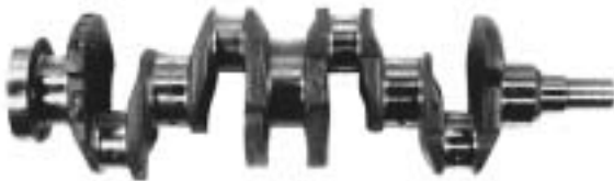
Vilebrequin en ADI pour un moteur Ford turbo-compressé. L'ADI est capable de satisfaire aux impératifs de fatigue à coût beaucoup moins élevé que l'acier forgé.
