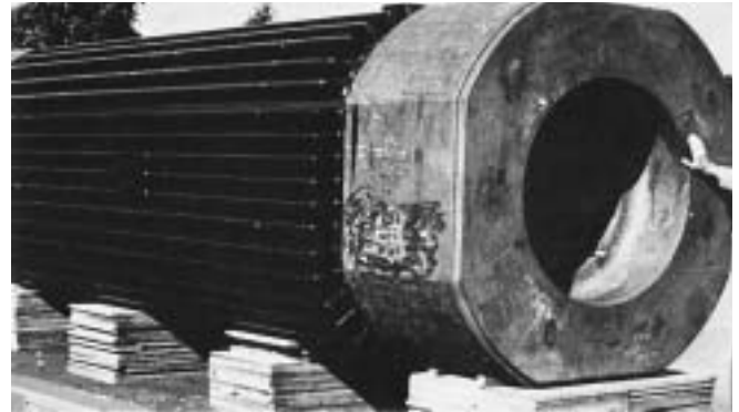
Pièce en fonte GS pesant 85 tonnes utilisée pour le stockage et le transport de barres usagées de combustible nucléaire. Les contrôles de l'AIEA (Autorité Internationale de l'Énergie Atomique) sont appliqués à ces pièces et celles-ci ont rencontré ces spécifications extrêmement serrées.
