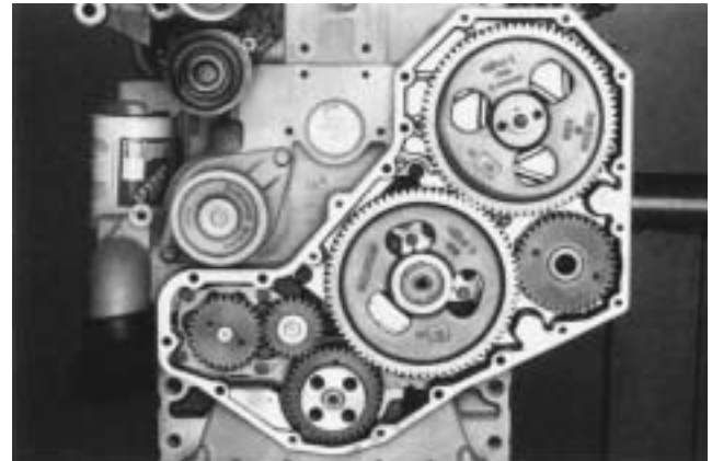
ENGRENAGE EN ADI DES MOTEURS DIESEL CUMMINS SÉRIE B QUI ONT REMPLACÉ L'ACIER 1022 FORGÉ ET CÉMENTÉ PROCURANT UNE ÉCONOMIE DE 30%.
